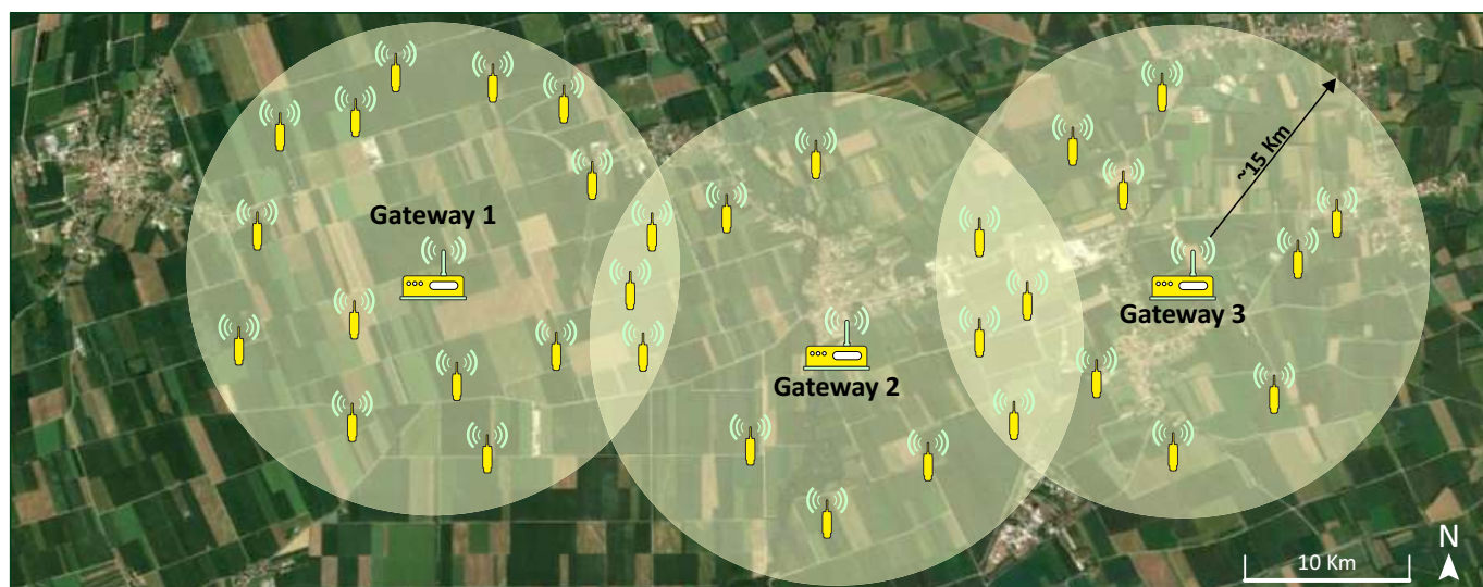
Fig.7 - Copertura della rete di comunicazione radio a stella non indirizzata
